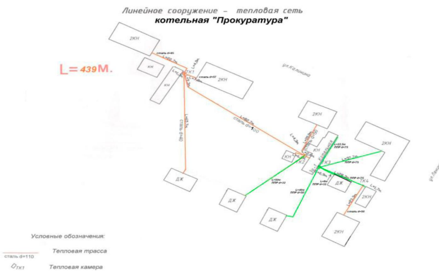
Рис. 3.1. Схема тепловой сети котельной с. Угловское «Прокуратура»
